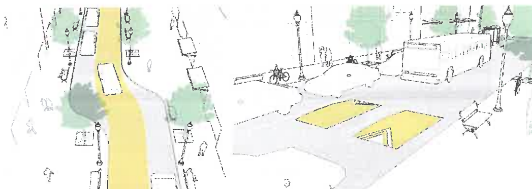
Fig. 3 Exemplos de soluções a implementar em zonas 30 para a redução de velocidade
